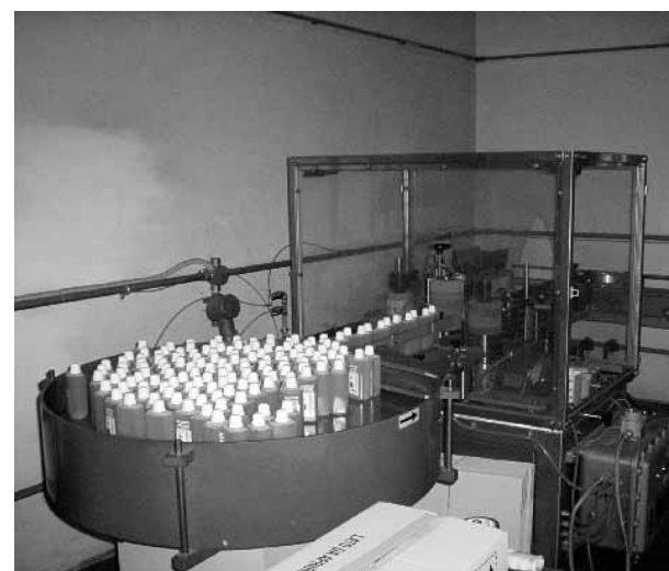
Il macchinario per imbottigliare l'alcool etilico
